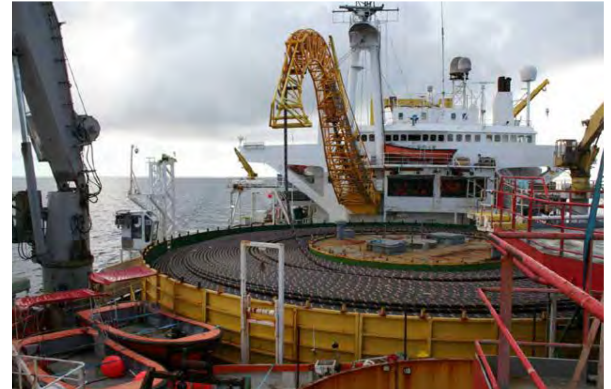
Mkongo wa chini ya bahari wenye urefu wa kilometa 75 kutoka Tanzania Bara hadi Pemba ukiwa botini tayari kuzamishwa baharini. Picha: John Alvsvåg (2009)
