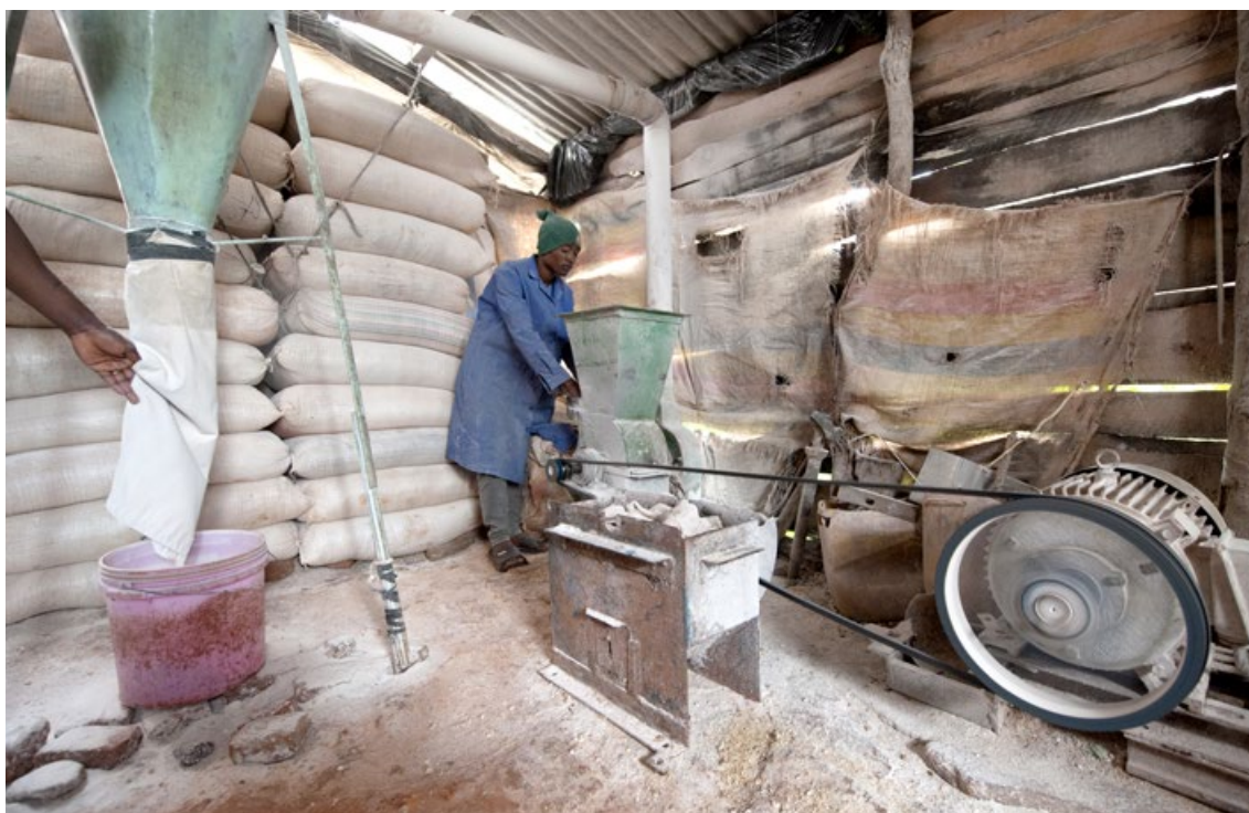
En maismølle i Lichinga som drives av strøm fra nettet. Med elektriske maismøller kan man male mais vesentlig raskere og med mindre innsats enn på en manuell kvern. FOTO: KEN OPPRANN
